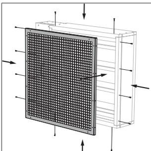
1. Setzen Sie das Abschlussgitter auf das Gehäuse und verschrauben Sie die Kanten mit den mitgelieferten Spanlattenschrauben Ø4 x 15 mm.
